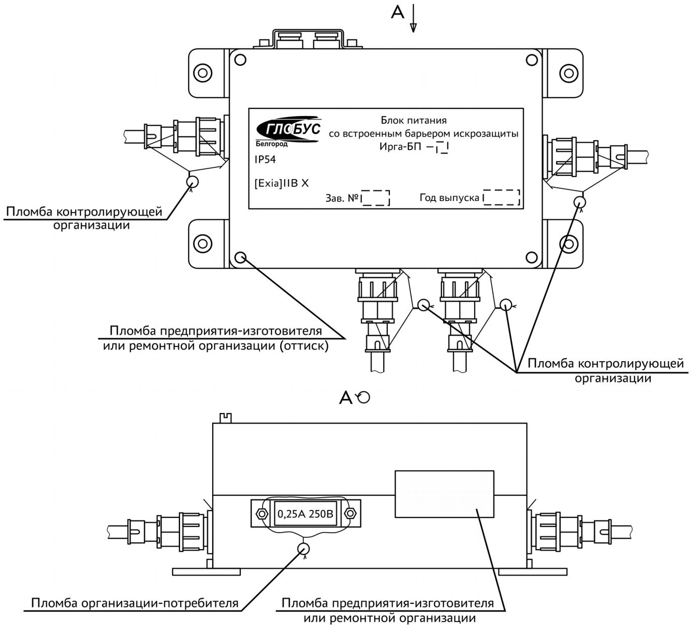
**И.2 Схема пломбирования расходомера с Ирга-БП и без датчика давления.**
