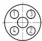
Рисунок 3 — Порядок затяжки гаек
