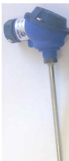
ж) термопреобразователь сопротивления ВЗЛЁТ ТПС
