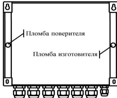
а) пломбирование тепловычислителя СПТ963
