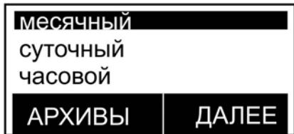
Рисунок 8 — Форма экрана ЖКИ в режиме «Архивы»
