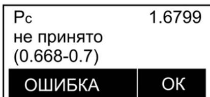
Рисунок 7 — Форма экрана ЖКИ в режиме «Ошибка»
