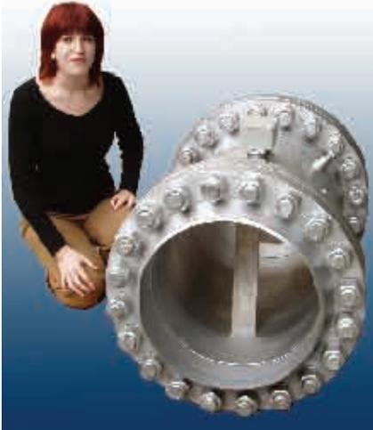
**Рис. 1.** Расходомер-счетчик «Ирга-РВ» (Ду 500 мм, Ру до 2,4 МПа) для ТПП «Когалымнефтегазпереработка».
