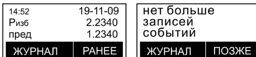
Рис. 11 – Экран ЖКИ в режиме «Журнал»
