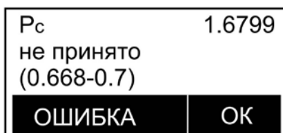
Рис. 7 – Экран ЖКИ в режиме «Ошибка»
